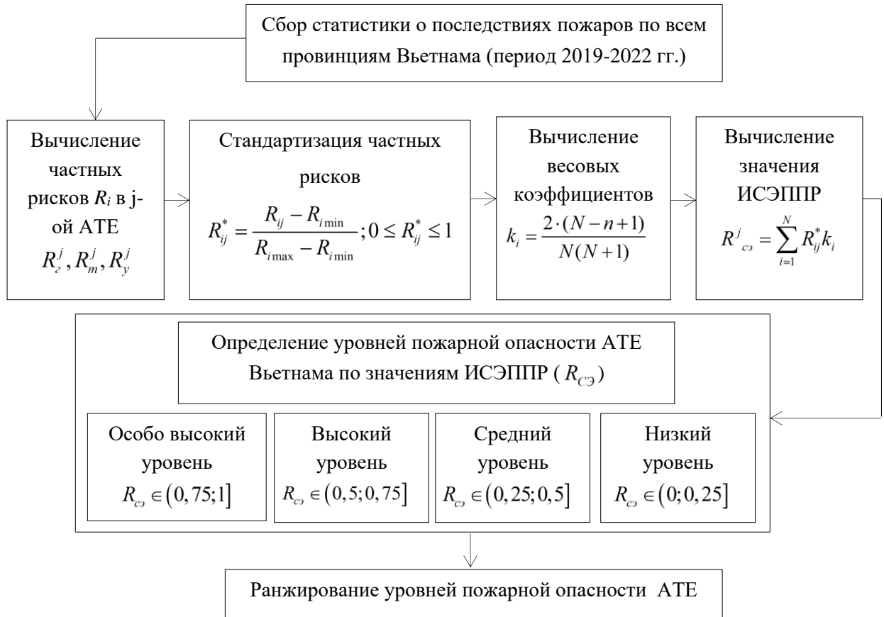
Рисунок 2.4 – Блок-схема оценки уровней пожарной опасности в АТЕ Вьетнама
